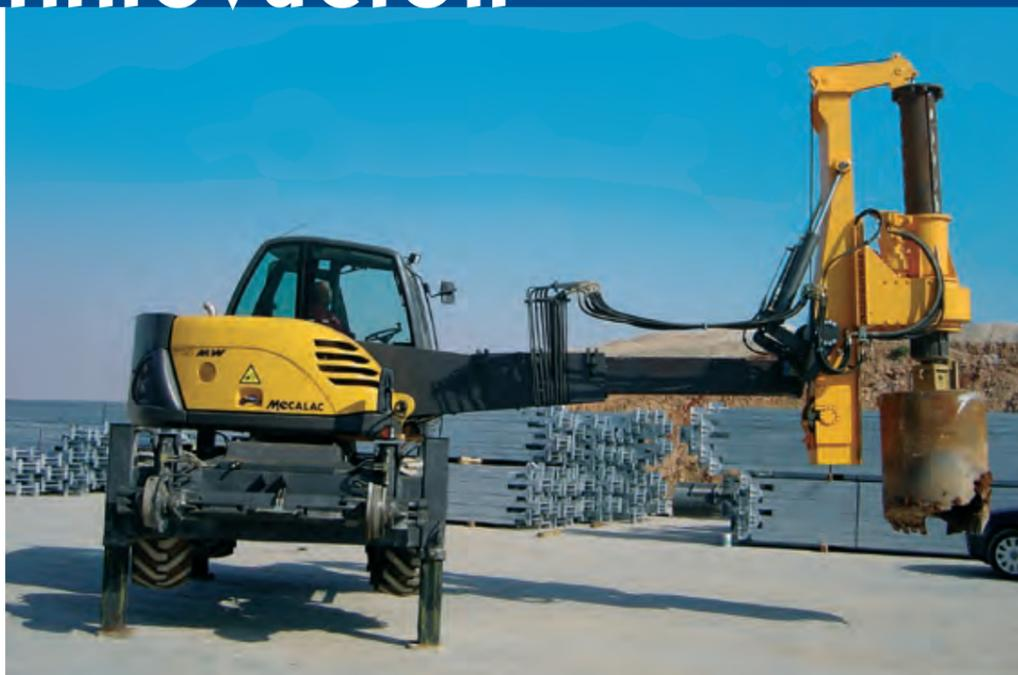
Nuestro taller de maquinaria nos permite dar inmediatez en la respuesta y exigencia de cada obra en particular, adaptando puntualmente las máquinas y ofreciendo una maniobrabilidad inusual. Hemos desarrollado una patente propia, denominada MAV, para la adaptación de las máquinas a la vía férrea, con un sistema de tracción hidráulica que eleva toda la máquina a más de 10 cm.
